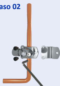
Instalación en la línea de servicio
